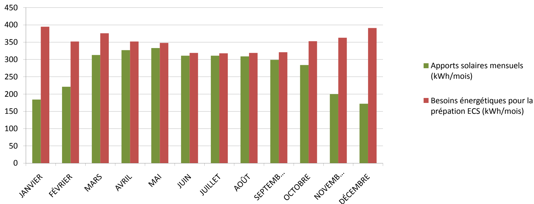
Part de l'énergie solaire ,récupérée pour couvrir les besoins de préparation ECS
